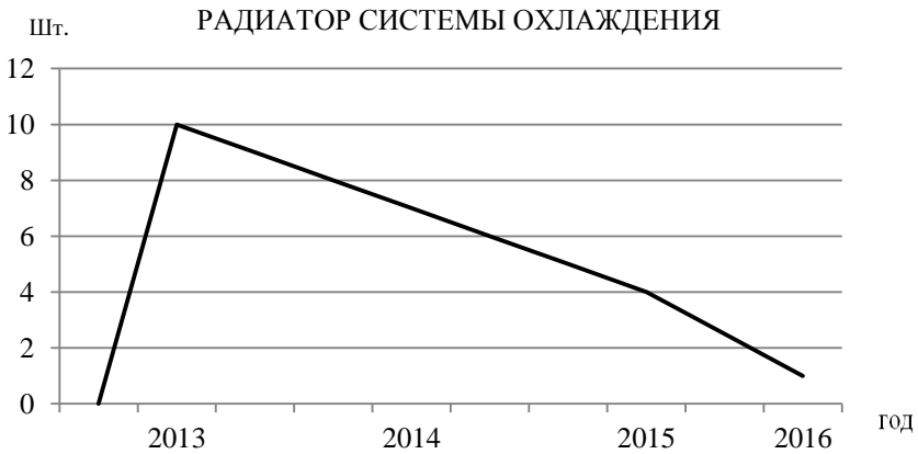
Рис. 5. Анализ отказов по силовой установке КамАЗ-6520 (65115) (радиатор системы охлаждения двигателя)
