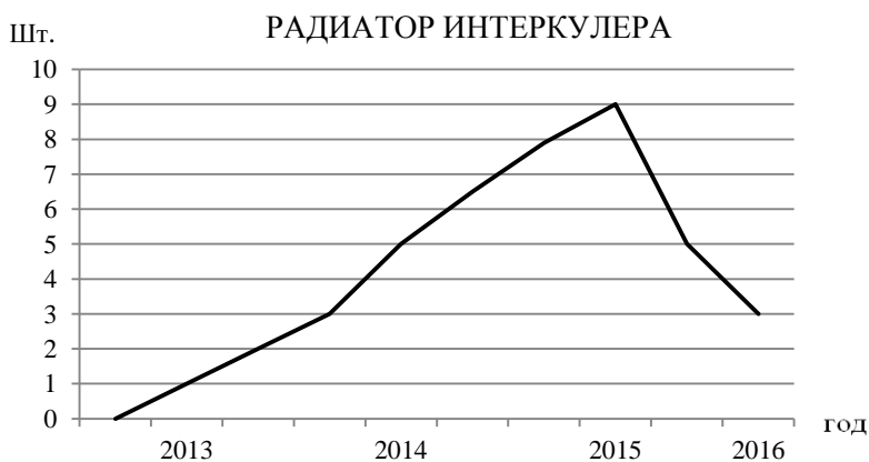
Рис. 4. Анализ отказов по силовой установке КамАЗ-6520 (65115) (радиатор интеркулера охлаждения воздуха)
