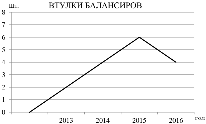
Рис. 8. Анализ отказов по ходовой части КамАЗ-6520 (65115) (втулки балансиров)
