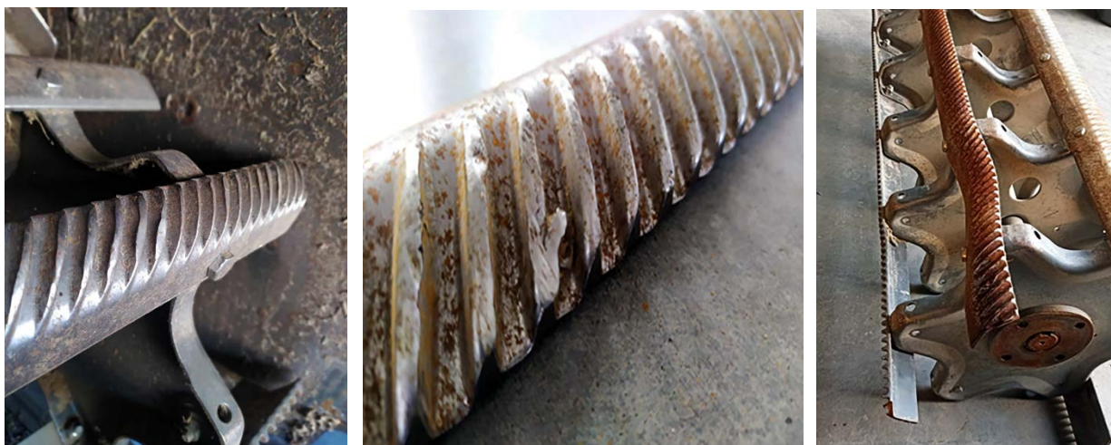
Рисунок 2 – Виды дефектов молотильного барабана
