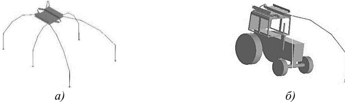
Рисунок 13 – Переносное быстровозводимое устройство, на которое натягивается теплоизоляционный чехол: а) устройство в развернутом виде; б) устройство на крыше кабины трактора
