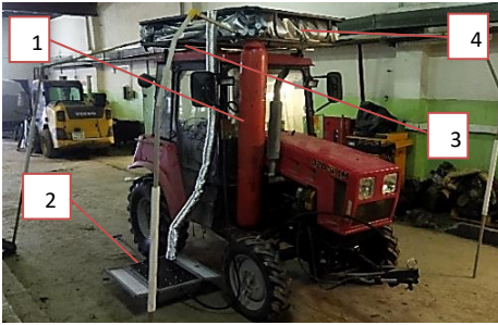
Рисунок 6 – Общий вид АММСС: 1 – баллон с биогазом; 2 – мобильное теплообменно-вентиляционное устройство; 3 – переносное быстровозводимое устройство для установки теплоизоляционного чехла; 4 – теплоизоляционный чехол.
