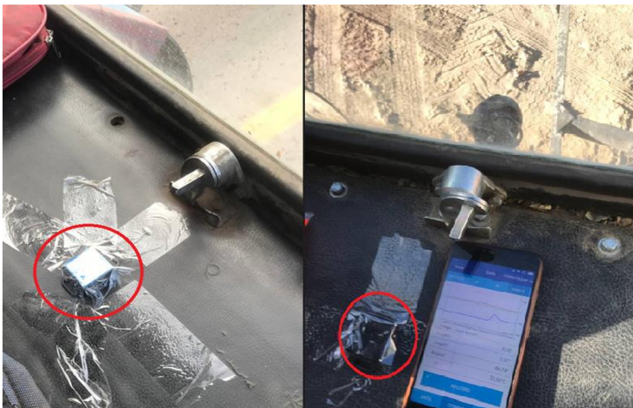
Рисунок 4.2- Фрагмент проведения исследований по отклонению от прямолинейного движения заднего моста трактора (слева-серийный трактор, справа-экспериментальный трактор)
