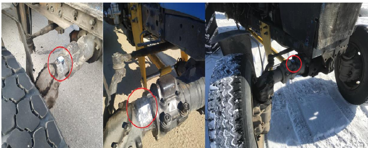
Рисунок 3.36- Фрагмент проведения исследований по отклонению от прямолинейного движения переднего моста трактора (слева-серийный трактор, справа-экспериментальный трактор)
