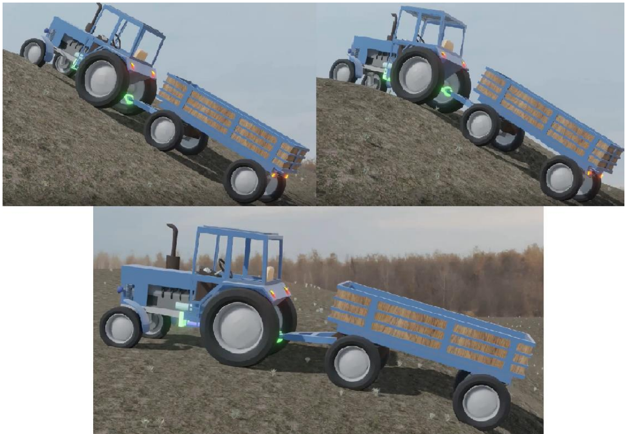
Рисунок 2.22- Фрагменты эмуляция движения экспериментального ТГА на подъем
