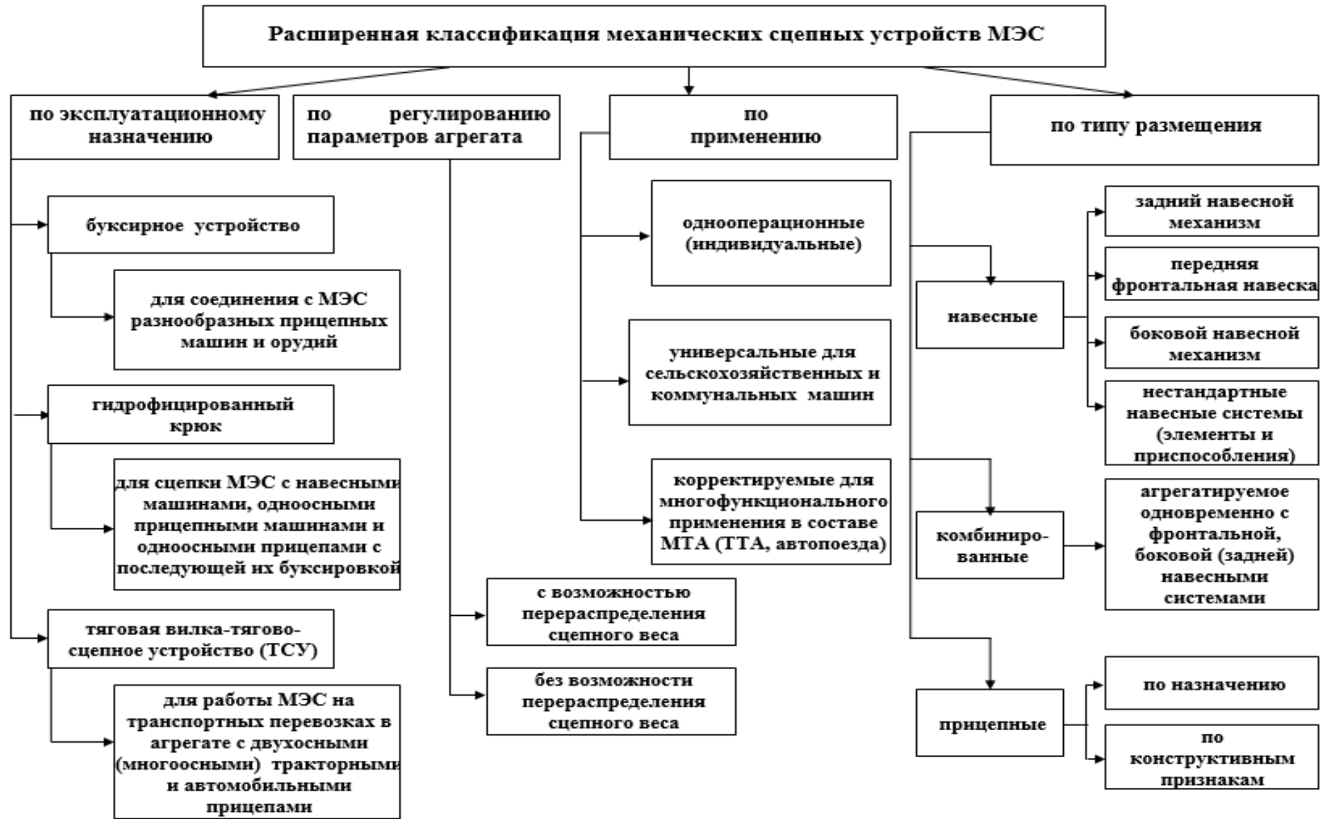
Рисунок 1.20- Расширенная классификация механических сцепных устройств мобильных энергетических средств
