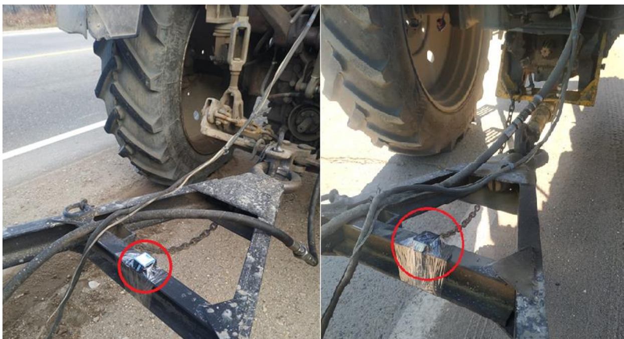
Рисунок 4.3- Фрагмент проведения исследований по отклонению от прямолинейного движения узла «тягово-сцепное устройство трактора-дышло прицепа» (слева-серийный трактор, справа-экспериментальный трактор)
