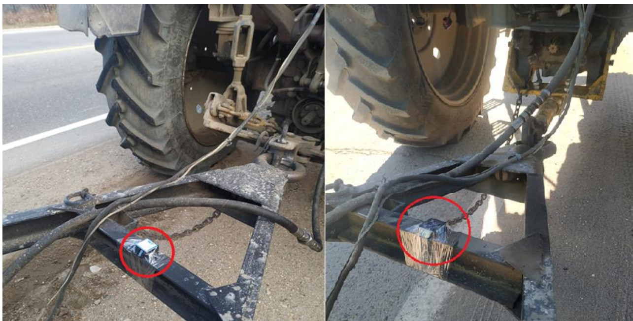
Рисунок 3.34- Фрагмент проведения исследований по отклонению от прямолинейного движения дышла прицепа (слева-серийный трактор, справа-экспериментальный трактор)
