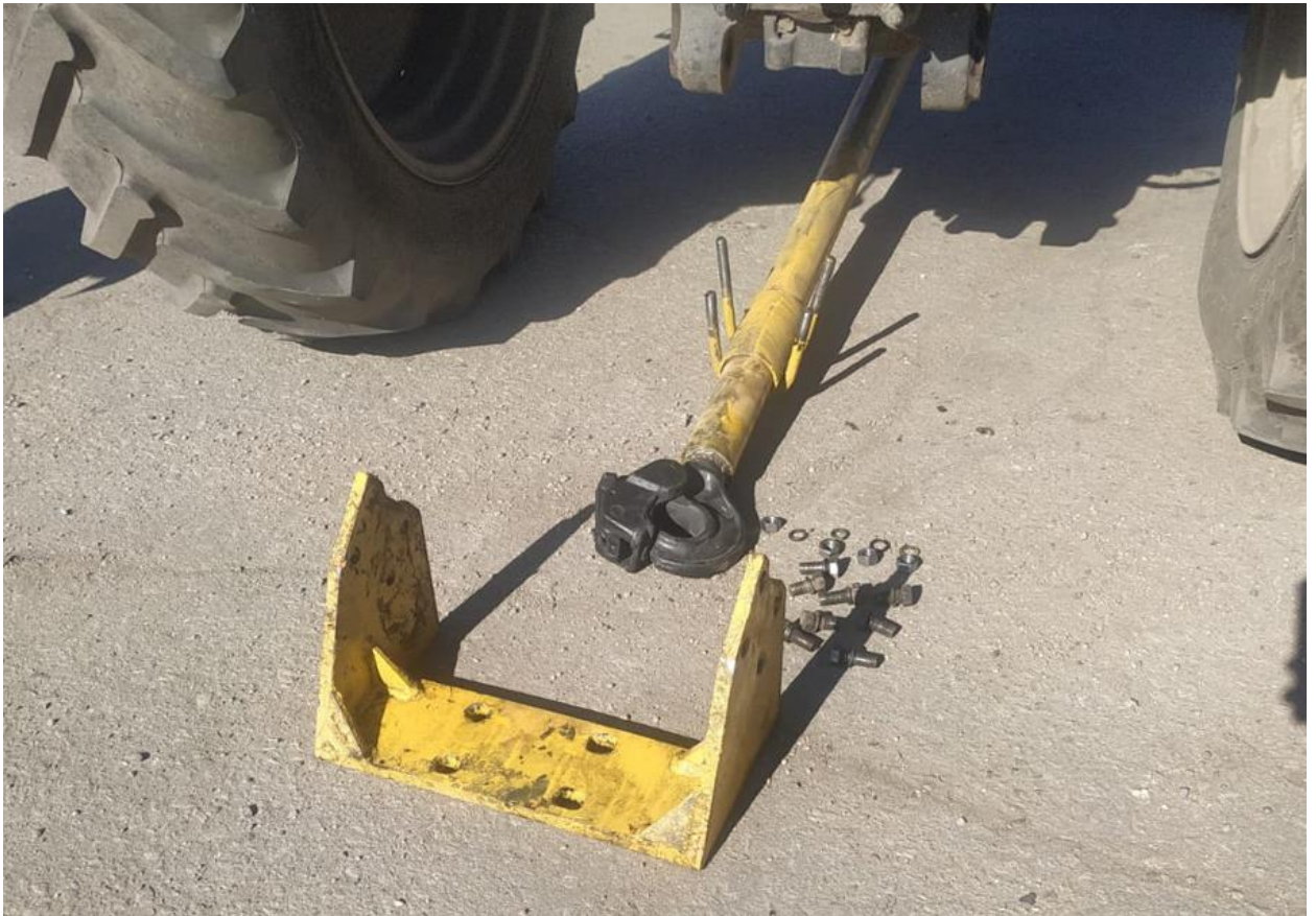
Рисунок 3.12- Общий вид соединения рессорной пружины и тяговой вилки
