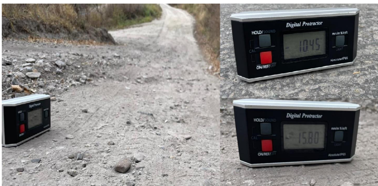
Рисунок 3.38- Фрагмент проведения исследований измерению углов наклона поверхности движения
