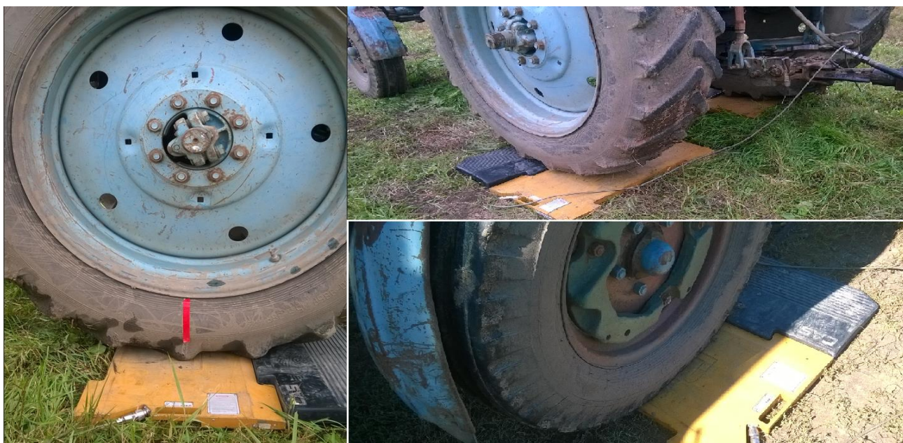
Рисунок 3.24 – Определение массы транспортного средства проводилось при помощи переносных подкладных весов типа CAS RW-10 (15) P
