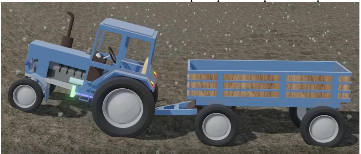
Рисунок 2.30- Фрагменты эмуляции движения при определении технологических и колебательных характеристик экспериментального агрегата
