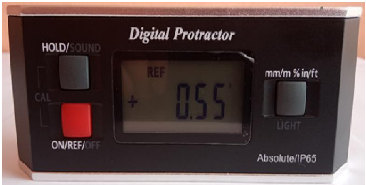
Рисунок 3.21- Инклинометр Absolute Digital Protractor
