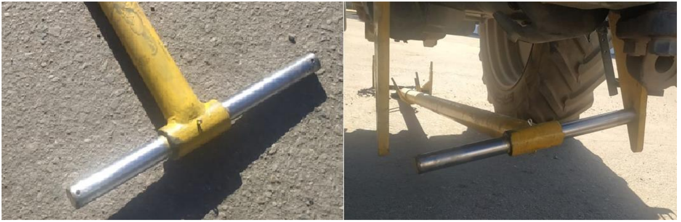
Рисунок 3.8 -Торсионная ось в процессе сборки конструкции
