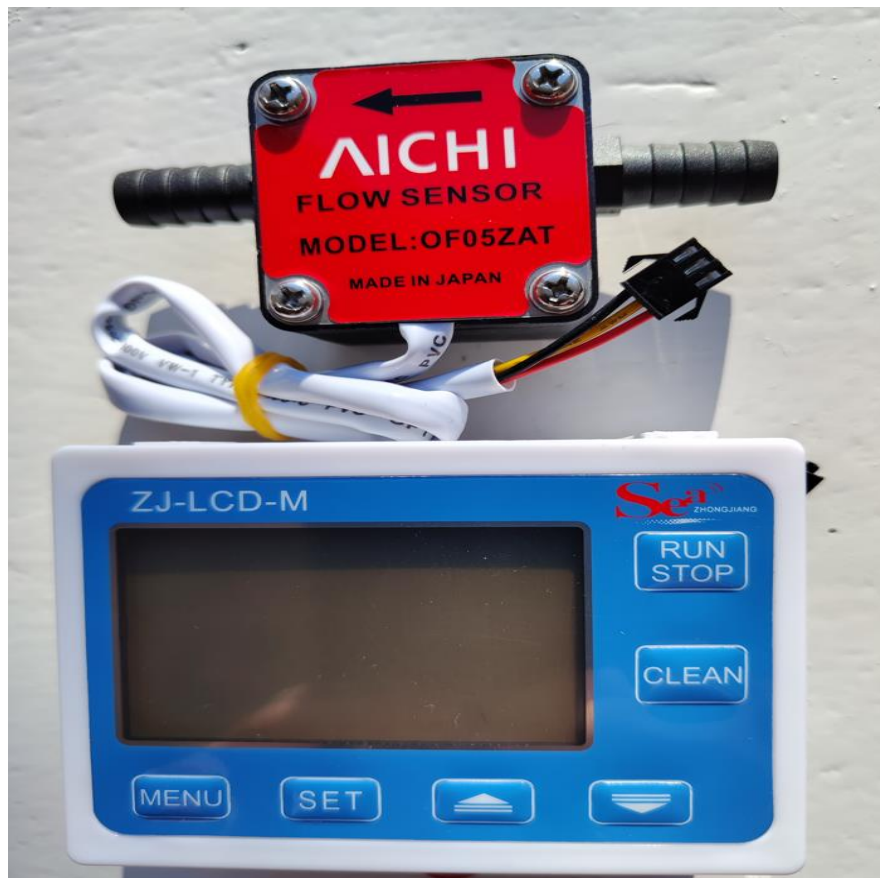
Рисунок 3.19 - Общий вид измерительной аппаратуры комплекса - контроллер расхода топлива ZJ-LCD-M с сенсором US211M модели OF 052AT
