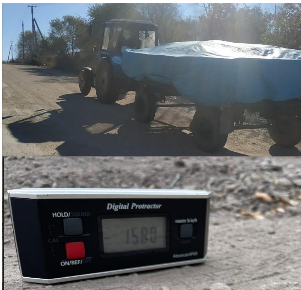
Рисунок 4.25- Фрагмент испытаний ТТА при движении на подъём
