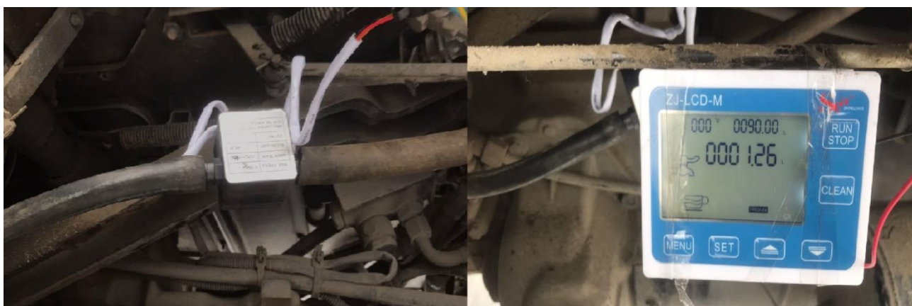
Рисунок 3.27- Позиция установки датчика и сенсоров в топливной системе трактора
