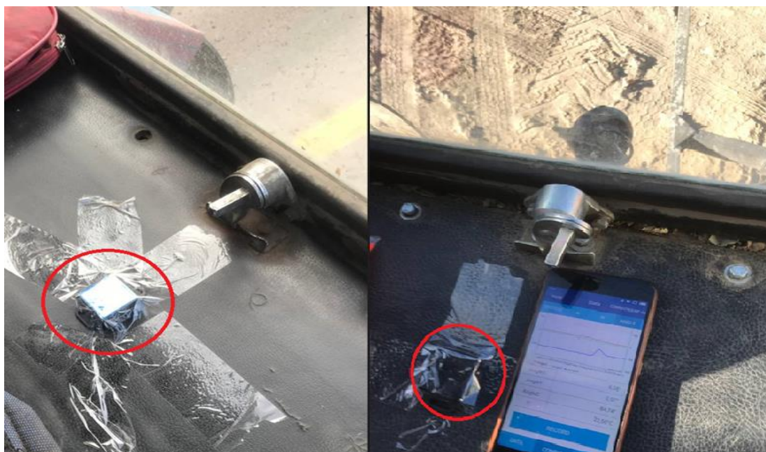
Рисунок 3.35- Фрагмент проведения исследований по отклонению от прямолинейного движения заднего моста и кормовой части трактора (слева-серийный трактор, справа-экспериментальный трактор)
