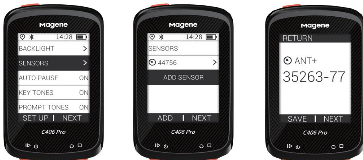
Рисунок 3.17 – Приборный комплекс GPS-навигатор MAGENE C406 Pro измерения пройденного расстояния, времени движения, скорости движения (частоты вращения ведущих колёс)
