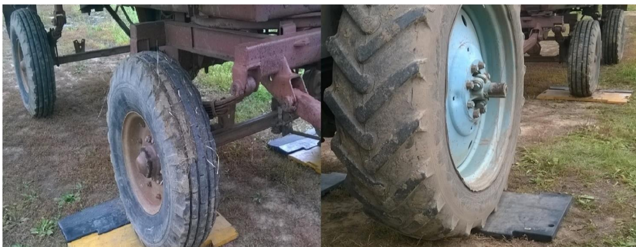
Рисунок 3.25 – Определение массы перевозимого груза, массы транспортного средства проводилось при помощи переносных подкладных весов типа CAS RW-10 (15) P
