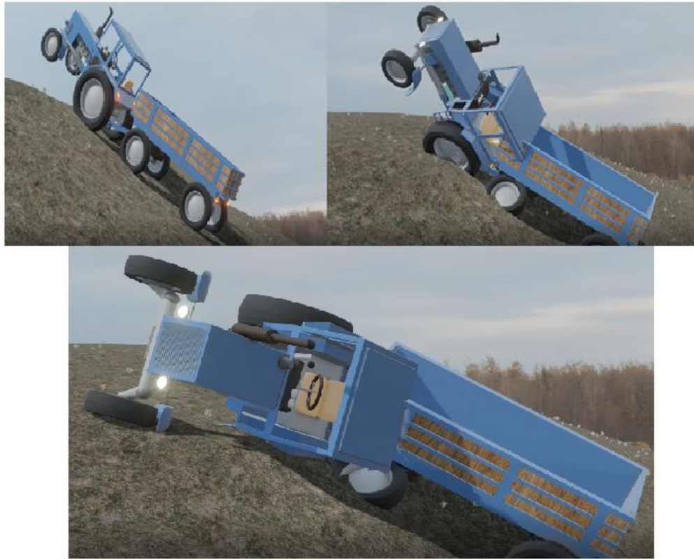
Рисунок 2.21- Фрагменты эмуляции опрокидывания при движении серийного ТГА на подъем
