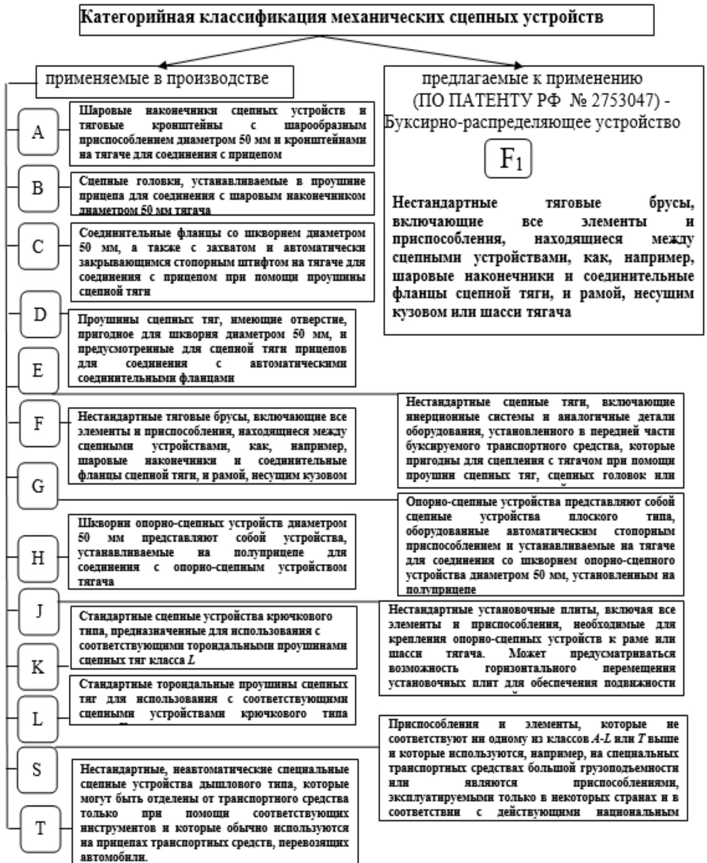
Рисунок 1.21- Категорийная классификация механических сцепных устройств[5]
