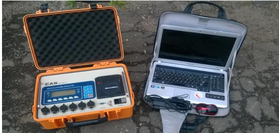
Рисунок 3.18 - Общий вид измерительной аппаратуры весоизмерительного комплекса CAS RW-10 (15) P
