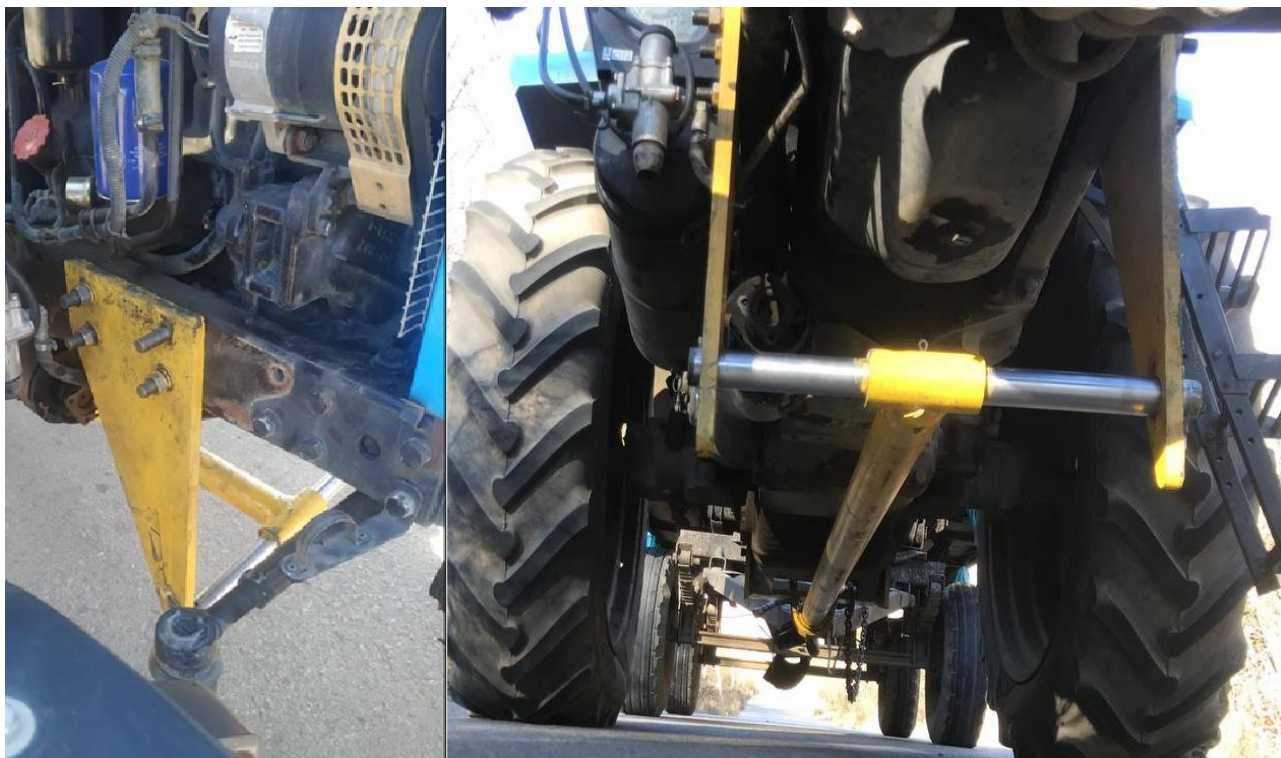
Рисунок 3.10- Угловые кронштейны, установленные на тракторе
