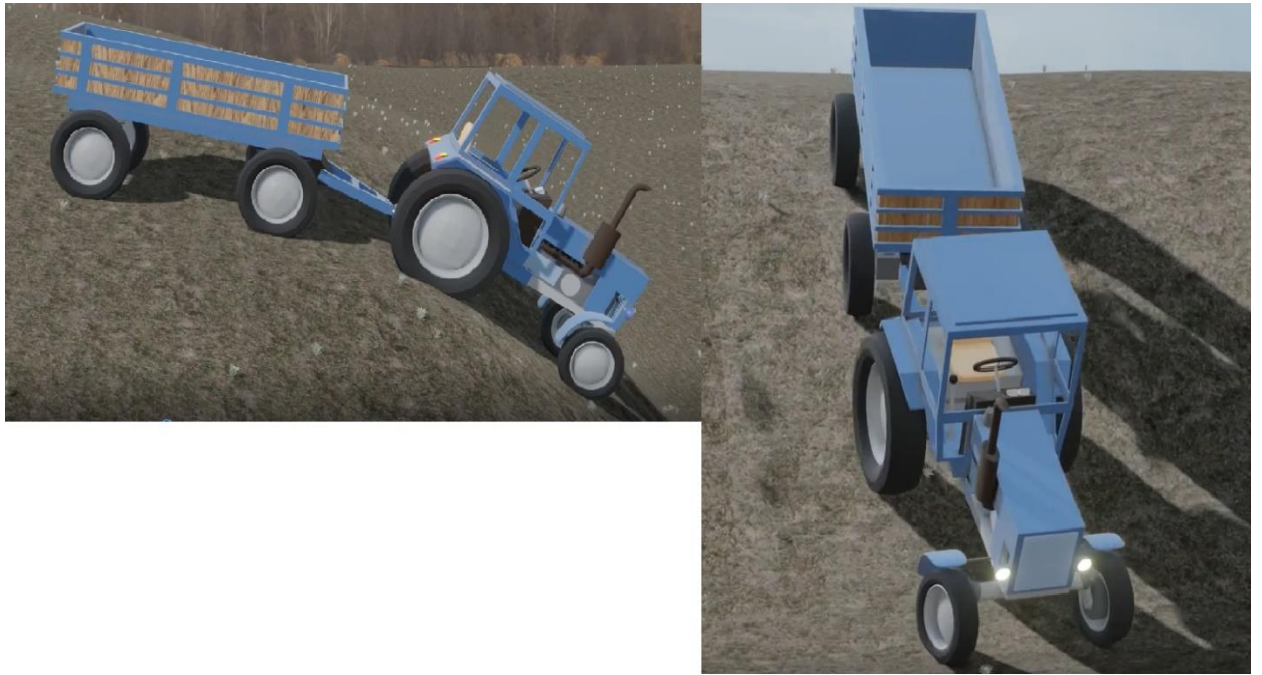
Рисунок 2.23- Фрагменты эмуляции движения серийного ТТА на спуске
