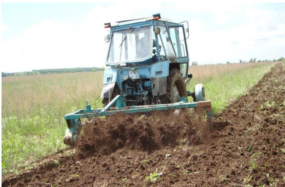
Рисунок 1.11 – Роторный плуг ОВПП-2,4 конструкции ДальНИИМЭСХ на обработке сидерата
