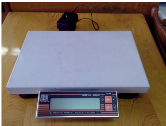
Рисунок 3.4 – Электронные весы Штрих-Слим № 01460 ТУ 4274-015-45915116-2006 (погрешность \pm 0,5 г)
