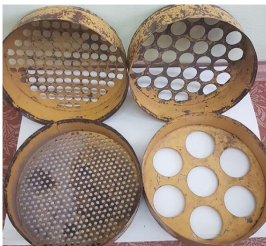
Рисунок 3.15 – Набор сит для определения фракционного состава почвы
