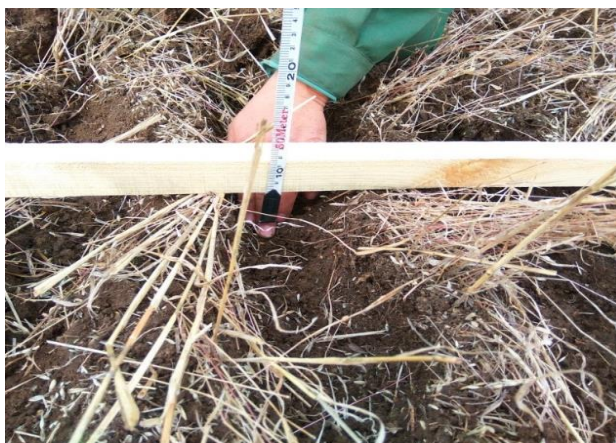
Рисунок 3.14 – Определение гребнистости поверхности почвы
