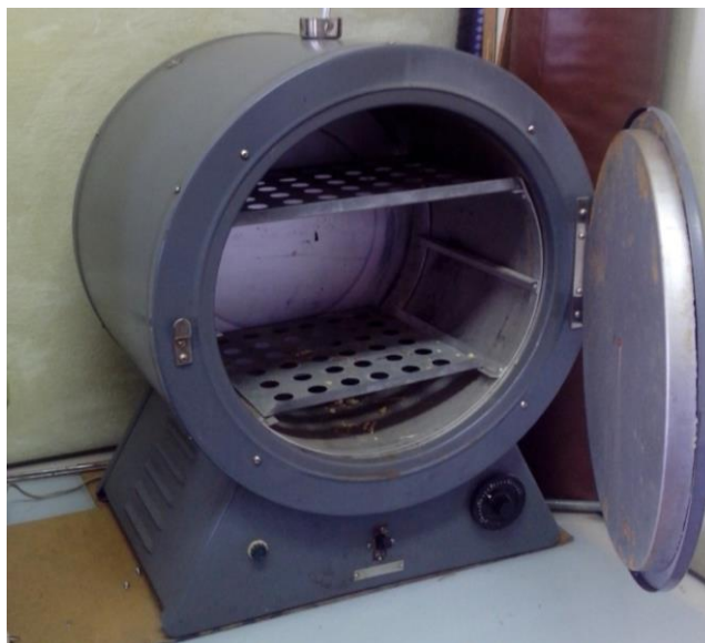
Рисунок 3.3 – Шкаф сушильный, круглый 2В-151, № 187 (погрешность \pm 1^\circ\text{C} )
