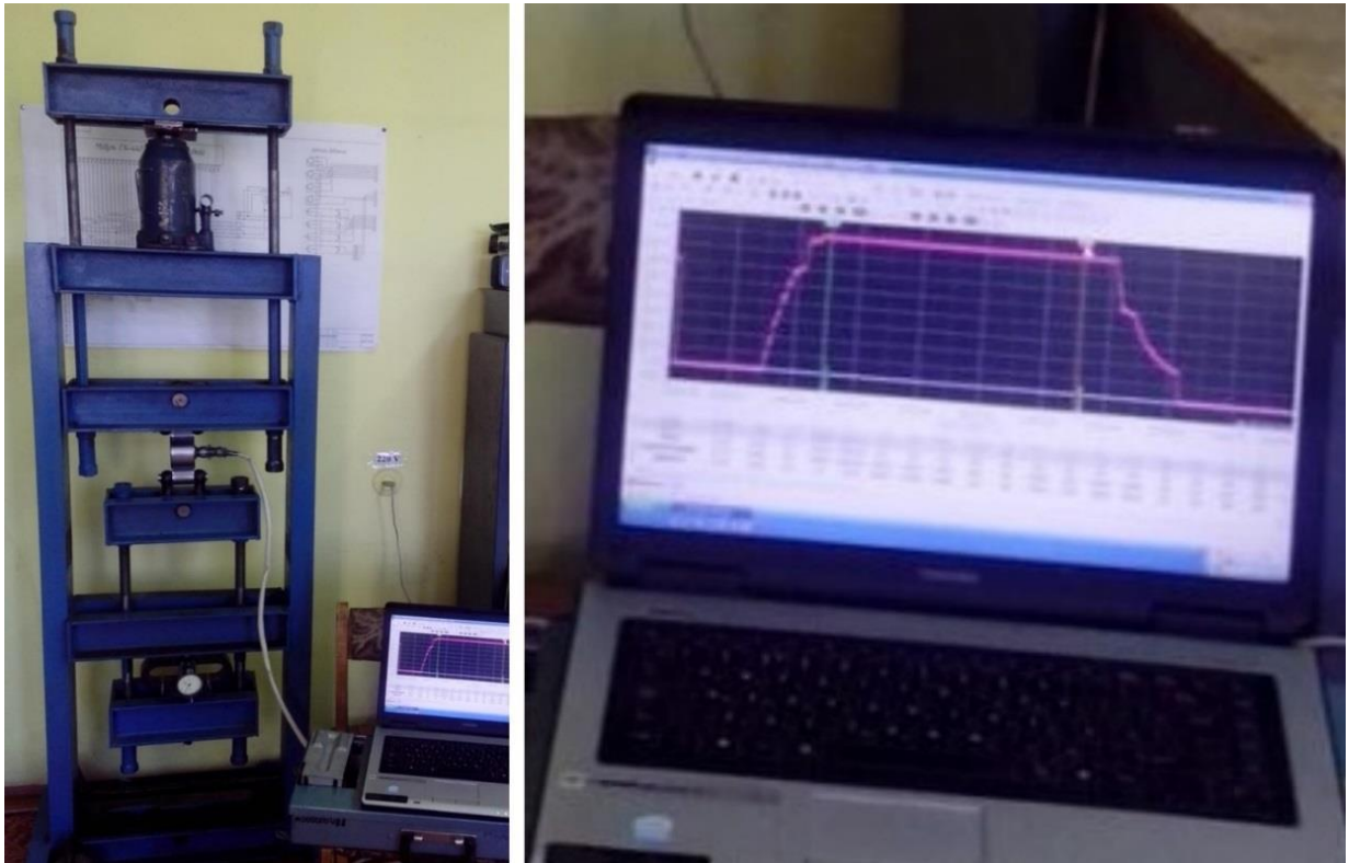
Рисунок 3.21 – Тарировка тензозвена на стенде
