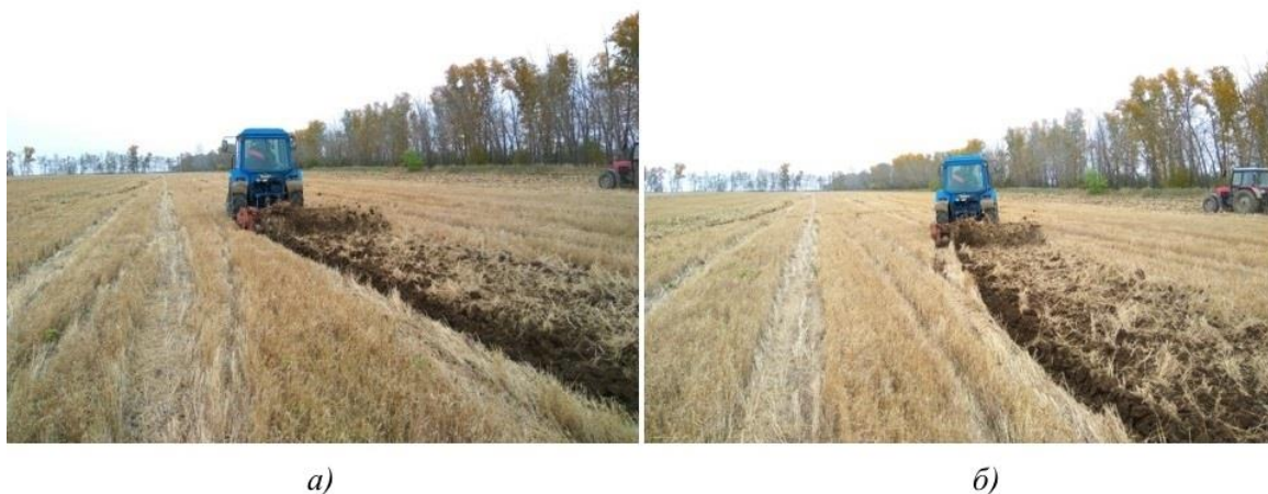
Рисунок 3.13 – Траектории движения тягово-приводного агрегата при основной обработке почвы роторным плугом:
