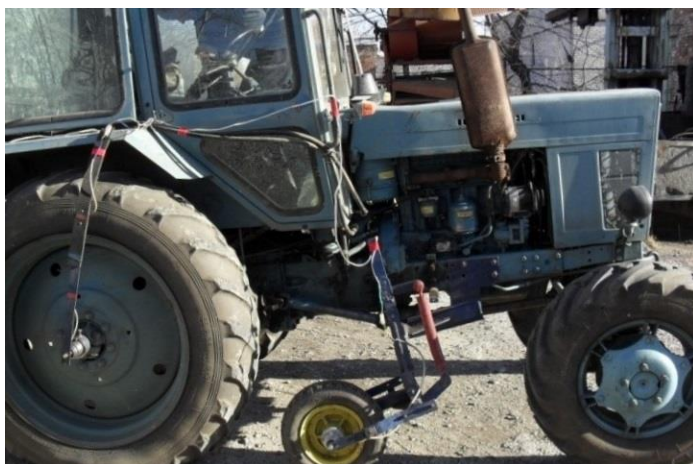
Рисунок 3.16 – Путеизмерительное колесо, установленное на трактор
