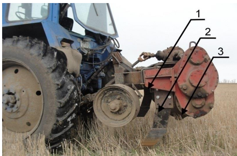
Рисунок 3.8 – Опытный образец модернизированного роторного плуга:
