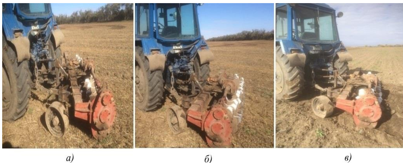
Рисунок 3.6 – Изменение угла атаки роторного плуга:
