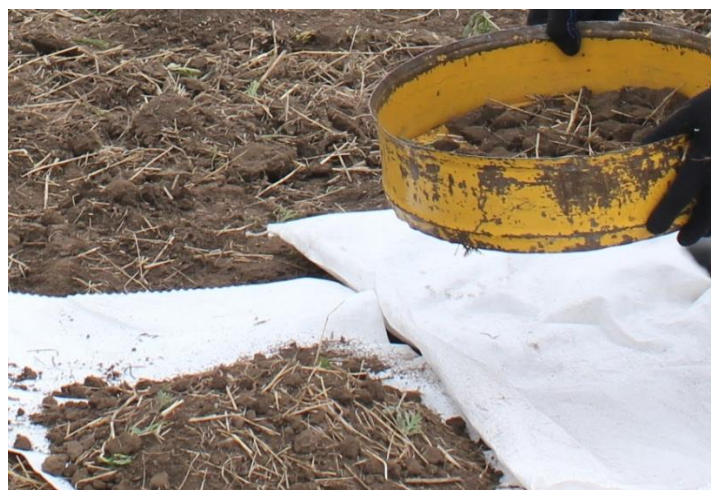
Рисунок 3.15 – Набор сит для определения фракционного состава почвы
